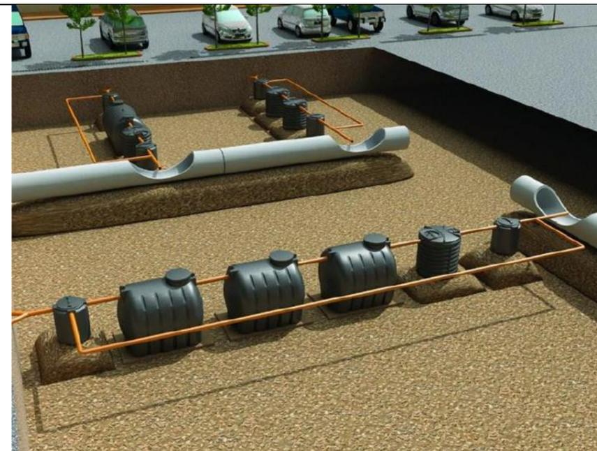
Per i sistemi di trattamento delle acque di pioggia potranno essere adottati sistemi “classici” di trattamento (impianto con sedimentazione/disoleazione) con sistemi di affinamento dello scarico con tecniche di fitodepurazione.
